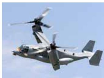
回転翼がエンジンと共に固定翼の両端に備わっている。これを離着陸時には上向きに、上空飛行時は前方に倒して通常の飛行機のように高速で飛行する。この回転翼とエンジンの角度変更は毎秒8度で動くため、90度の変更には11秒程度かかることになる。離着陸は滑走路が短く搭載量が少ない時は垂直に離着陸できるが多くは滑走路があればエンジンとローターを垂直よりも前方の75度や60度に傾けて回転翼と固定翼の両方の揚力を得て上昇離陸及び短距離進入降下を用いた短距離離着陸（STOL）を採用することが多い。問題はローターを完全に前方にしたままでは地面をこすってしまうことである。
