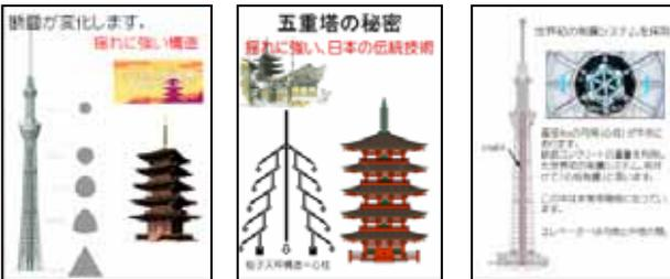
鉄筋コンクリート製のなんと高さ 375m の構造物がスカイツリー本体と分離した形で立つことで、地震の際、本来とは異なる動きをしてスカイツリー全体の揺れを抑えるそうです。また、スカイツリーに隣接する「すみだ水族館」では大成建設の人工海水が使われています。塩化ナトリウムなどが入った海水の成分となる「海水のもと」を施設内の溶解槽に投入して、機械でかき混ぜた後、薄めて使用する。
